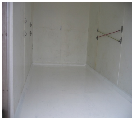
Véhicule de collecte adapté vu de l'intérieur (système retenant les bennes aux parois, surfaces lavables, coins arrondis...)
